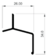
Top rain gutter
